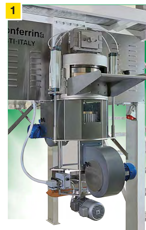
1 - Particolare testa estrusore con trafilatura penne
