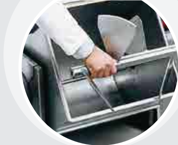
1 - Vasca ribaltabile Turnable tank
