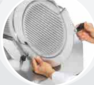
5 - Pratico smontaggio del coprilama Easily removable blade cover
