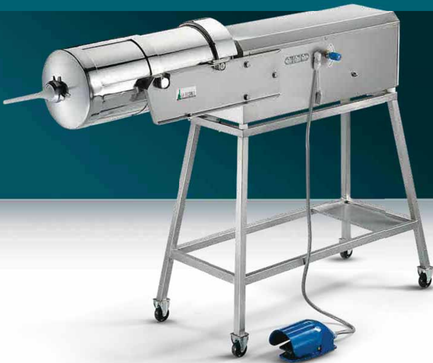
3 - Protezione cilindro oleodinamico e valvole sfiato aria tampone Hydraulic cylinder protection and pad exhaust valves
