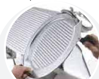
10 - Pratico smontaggio del coprilama Easily removable blade cover
